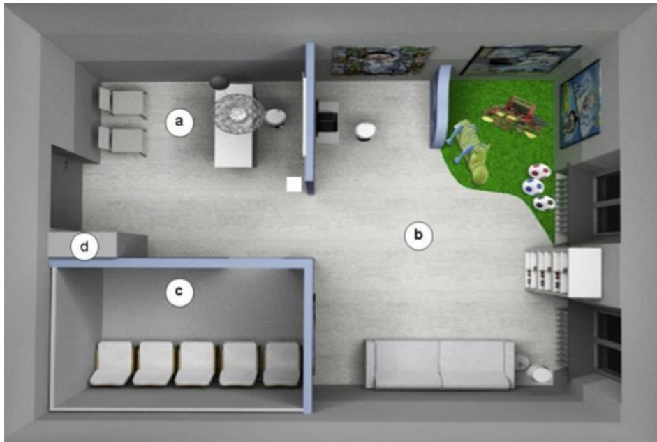
图 1 所示：“盐诊所”三维设计:接待/欢迎区(a);设有儿童游乐区的等候室(b); “Aerosal”盐疗室(c).耳鼻喉科(d).装有干盐气溶胶发生器的柜子
